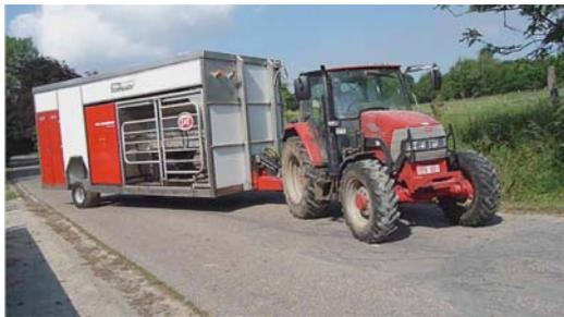
Figure 2. Remorque contenant le robot tractée pour le déplacement en prairie.
