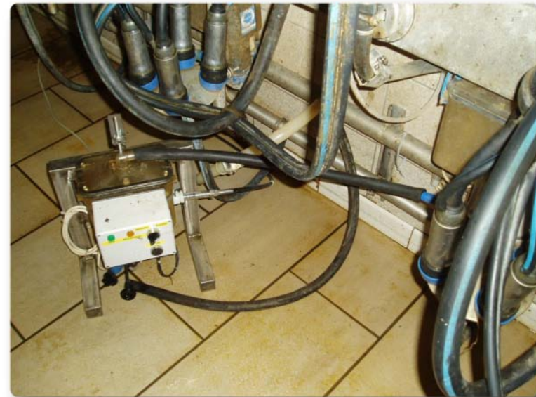
Figure 2 : Dispositif automatisé NIR, installé à un poste de la salle de traite du CRA-W.
