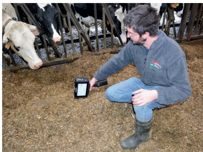
L'étude a évalué quatre spectromètres proche infrarouge portables.
