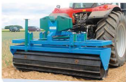
Rouleau Crimper, roulé (RC)
