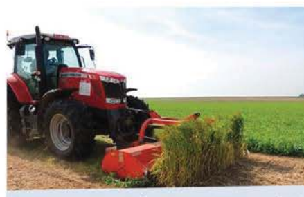
Broyeur à marteaux, broyé non incorporé (BNI)
