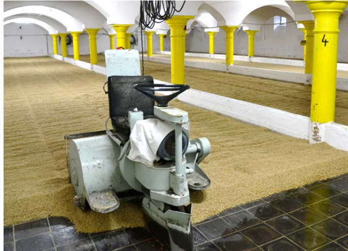
Fig. 10. Maltomobile tchèque pour retourner la couche.
