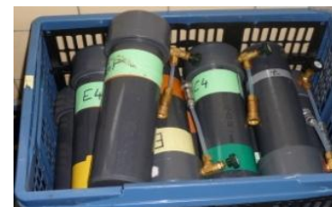
Fig. 3 : Bombonnes de stockage du CH 4
