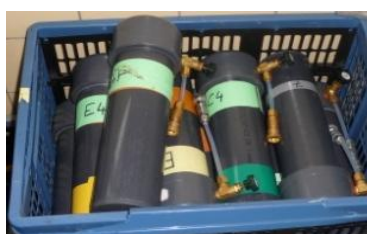
Fig. 3: Bonbonnes de stockage du CH 4
