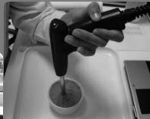
Figure : Analyse de la viande hachée par spectrométrie proche infrarouge couplée à une fibre optique.
