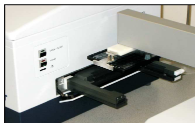
Figure 8 : Micro plaque insérée dans le tiroir motorisé
