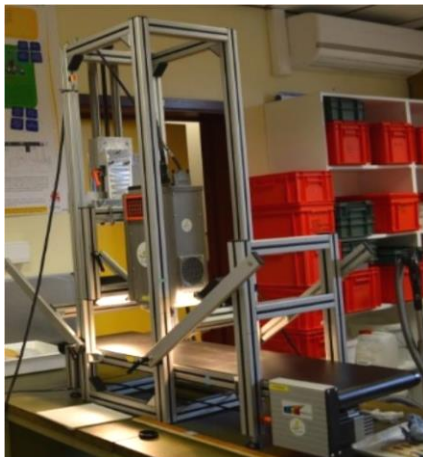
a) Caméra hyperspectrale NIR utilisée pour scanner les fèves
