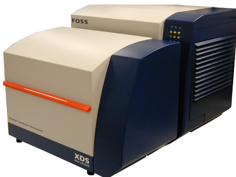
Figure 21 : Instrument de spectrométrie proche infrarouge (Foss XDS) (CRA-W)
