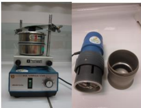
Figure 18 : Dispositif de tamisage (CRA-W) Figure 19 : Instrument de broyage (CRA-W)
