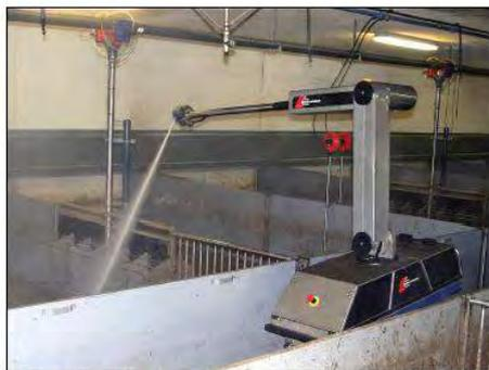
Fig. 6 Un robot de nettoyage à haute pression permet d'alléger le travail
