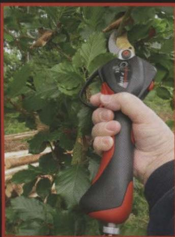
Le sécateur Electrocoupe F3010 est bien plus qu'un simple sécateur électronique. Cet appareil offre la possibilité de changer de tête de coupe en fonction du travail que vous souhaitez effectuer. Il peut être fixé sur une perche pour la taille à moyenne et grande hauteur.
