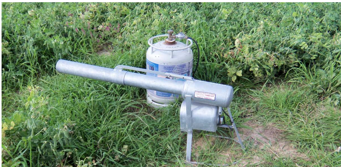
PHOTO 5 : Canon au propane muni d'une cellule crépusculaire (source : CRA-W)
