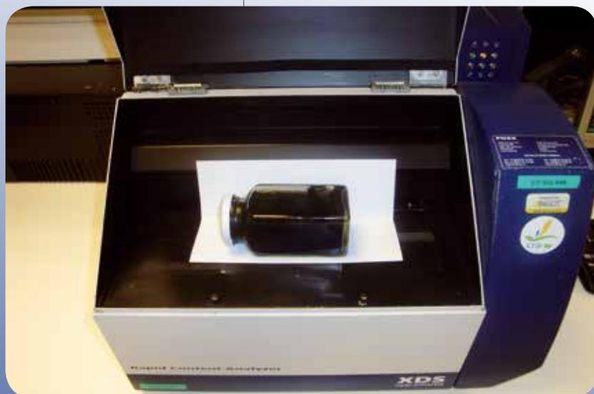
Figure 30 : Mesure infrarouge d'un bocal contenant du lisier. (Source : Laboratoire d'Encadrement Référentiel).
