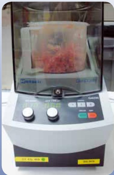
Figure 26 : MixerLab utilisé pour broyer les échantillons. (Source : Laboratoire d'Encadrement Référentiel).
