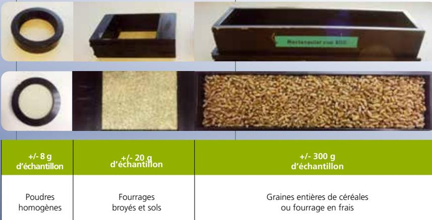
Figure 11 : Les cellules de mesure utilisées par le réseau REQUASUD pour les mesures PIR. (Source : Laboratoire d'Encadrement Référentiel).
