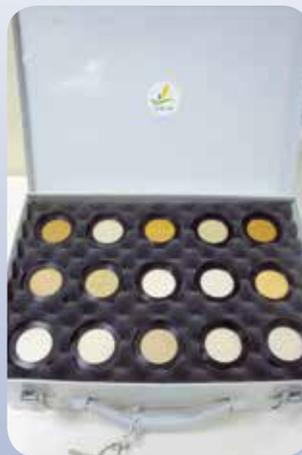
Figure 14 : Boite de standardisation contenant des échantillons standards utilisés par le Laboratoire d'Encadrement Référentiel pour rendre similaire la réponse spectrale des spectromètres du réseau REQUASUD.
