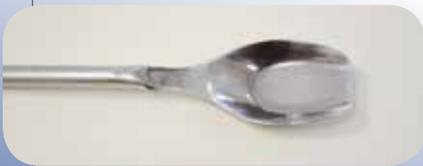
Figure 12 : Spatule à bord droit recommandé pour le remplissage des coupelles de mesure. (Source : Laboratoire d'Encadrement Référentiel).
