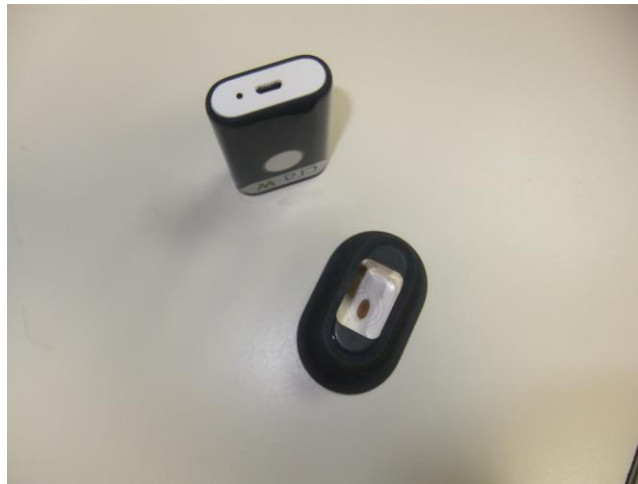
Figure 50 : Photo personnelle d'un grain de blé dans le support du SCIO avant le SCAN (CRA-W, unité 14, 2017)
