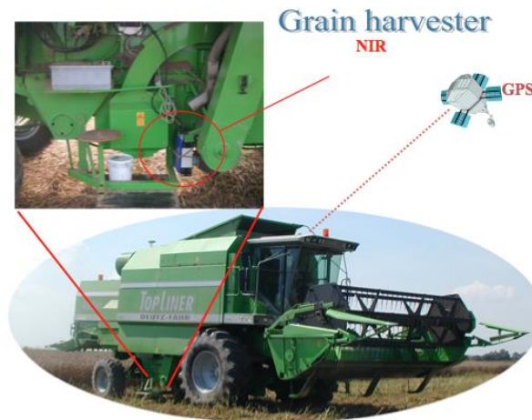
Figure 16 : Photo d'un spectromètre placé sur une moissonneuse (PowerPoint CRA-W)
