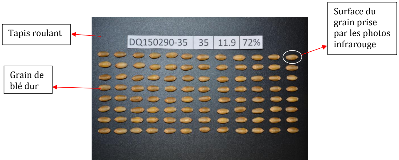
Figure 53 : Photo personnelle de l'alignement des grains sur le tapis de la caméra infrarouge (CRA-W, unité 14, 2017)
