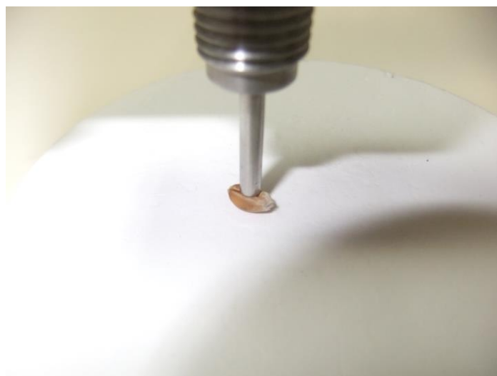
Figure 54 : Photo personnelle de la surface du grain prise par la sonde ASD lors d'un scan (CRA-W, unité 14, 2017)
