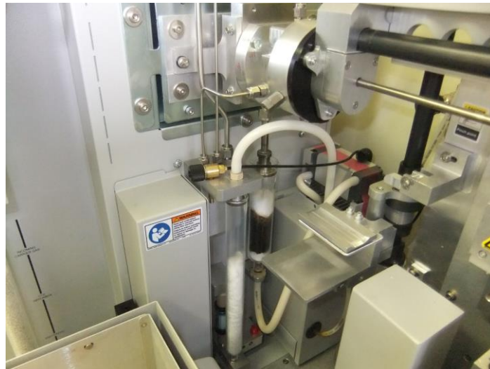
Figure 57 : Photo personnelle du tube primaire et secondaire + joints lèvres (CRA-W, unité 14, 2017)
