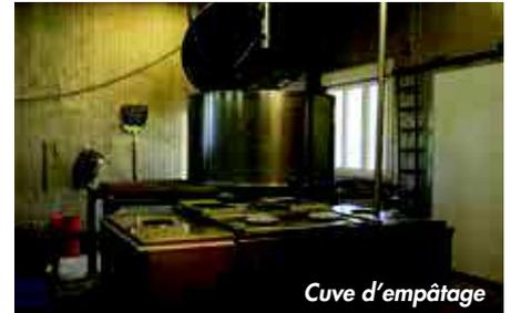
d'eau chaude permet d'amener le mélange à 68 °C, température optimale de fonctionnement des enzymes nécessaires. Après une heure trente d'infusion, l'ensemble de l'amidon du grain est transformé, le moût de bière est prêt et peut être filtré et transféré vers la cuve de houblonnage. Les drêches (résidus du filtrage) sont données à une ferme laitière de Saint-Gravé ; de cette manière, rien ne se perd !
