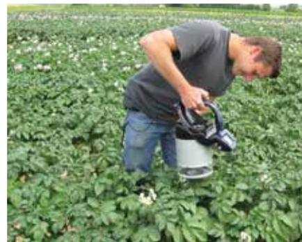
En photos: les capteurs optiques de terrain reposant sur la fluorescence chlorophyllienne des feuilles - Dualux et Multiplex
