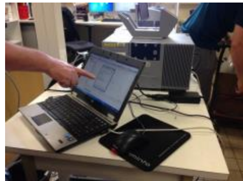
Figure 2 - Matrix-F relié à l'ordinateur avec Logiciel OPUS 7.5
