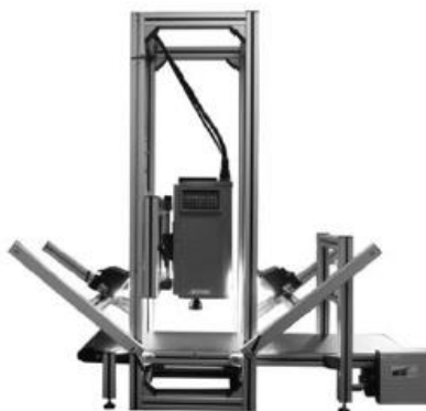
Figure 45: Système d'acquisition des images hyperspectrales proche infrarouge (BurgerMetrics SIA, Riga, Latvia). L'échantillon qui est éclairé par deux spots halogènes est posé sur une bande transporteuse et passe sous la caméra.
