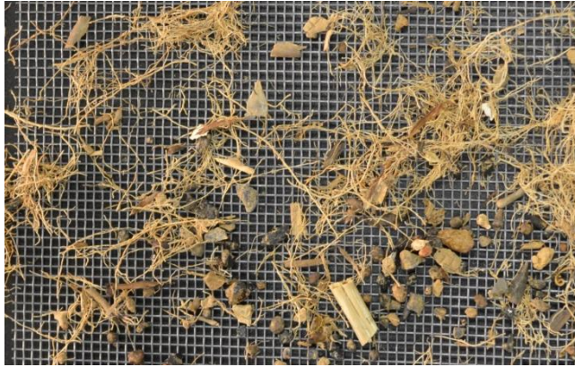
Figure 46: Racines de froment, racines de pois, nodosités, fragments de pailles, particules de terre et cailloux extraits d'un échantillon de sol, étendus sur le grillage de support et posés sur la bande transporteuse de la caméra hyperspectrale proche infrarouge. Les éléments sont disposés de telle manière à éviter tant que possible qu'ils se recouvrent. Un spectre proche infrarouge va être acquis pour chaque pixel de l'image.
