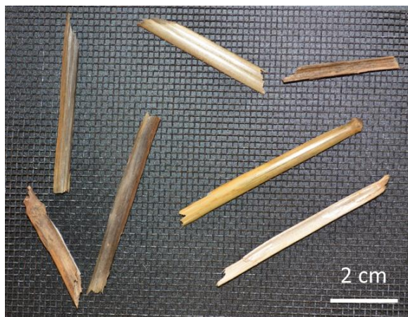
Figure 22: Standard paille. Échantillon de référence constitué de sept fragments de pailles de froment d'hiver et utilisé pour suivre la stabilité des mesures réalisées avec le système d'acquisition d'images hyperspectrales proches infrarouges et estimer la qualité de ces images.
