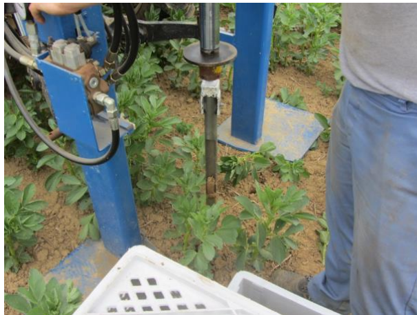
Figure 2: Prélèvement de carottes de sol à l'aide d'une sonde enfoncée dans le sol par un vérin hydraulique.
