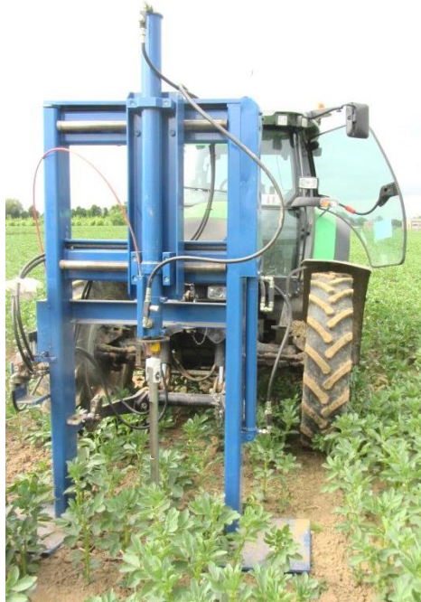
Figure 15: Vérin hydraulique et sonde permettant le prélèvement de carottes de sol.
