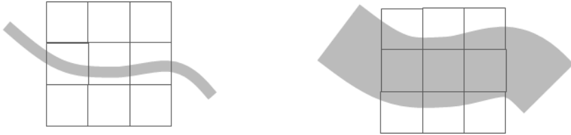
Figure 68: Représentation schématique de l'acquisition de spectres sur des racines de différentes épaisseurs. Chaque carré représente la surface d'un pixel. Les spectres des pixels qui ne sont pas acquis entièrement sur une racine peuvent être mal prédits par les modèles de discrimination.
