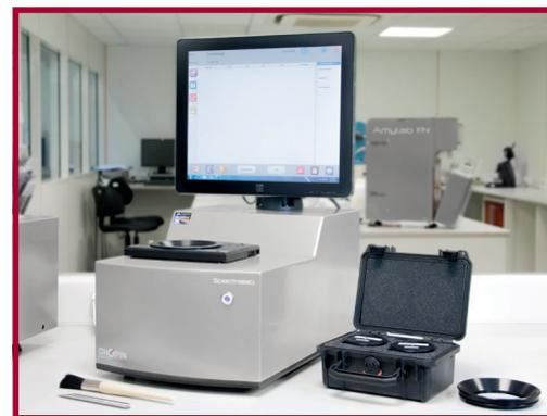
Pour atteindre cet objectif, la mesure doit être extrêmement précise. La méthode de référence (NF ISO 2171), utilisant le four à cendres, fournit cette précision, mais elle nécessite 3 heures, ce qui ne permet pas de s'en servir comme outil de contrôle et d'optimisation du processus de fabrication.
