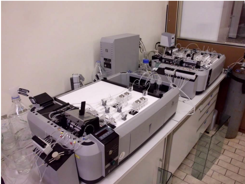
Figure n°1 : Les deux blocs principaux de l'AFC : le premier permet l'analyse de l'urée et du lactose tandis que le reste des analyses se passe sur le deuxième. (Photo : G.Bille)
