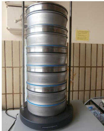
Figures 3 et 4. Placer la colonne au centre de la tamiseuse.
