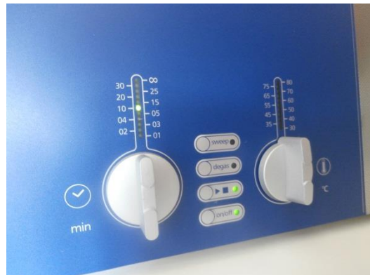
Figure 9 et 10. Disposer les tamis dans le bain à ultrasons et régler et mettre en route le bain à ultrasons.
