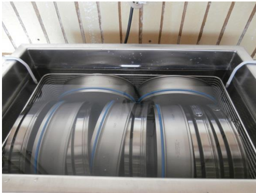
Figure 9 et 10. Disposer les tamis dans le bain à ultrasons et régler et mettre en route le bain à ultrasons.
