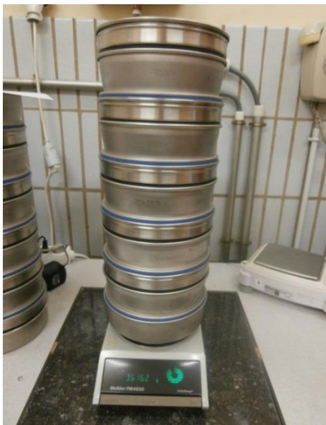
Figure 1. Empilement des tamis et pesée des tares cumulées.
