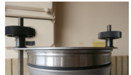
Figure 5. Système de fixation de la colonne.
