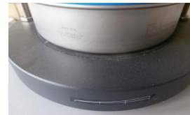
Figures 3 et 4. Placer la colonne au centre de la tamiseuse.
