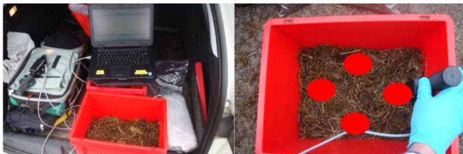
Figure 6: Illustrations des analyses effectuées à la ferme dans le bac de mesure à l'aide du spectromètre infrarouge portable FieldSpec 4.
