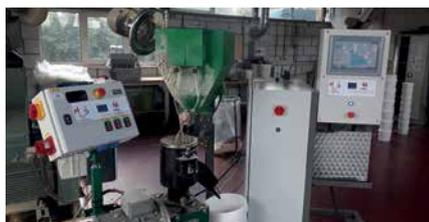
dans la fabrication de pellets, à partir de différents résidus de biomasses, sylvicoles et agricoles. L'objectif principal porte sur l'optimisation énergétique de ce processus de conditionnement, par l'évaluation des différents paramètres opératoires et de leurs effets sur le procédé de granulation.
