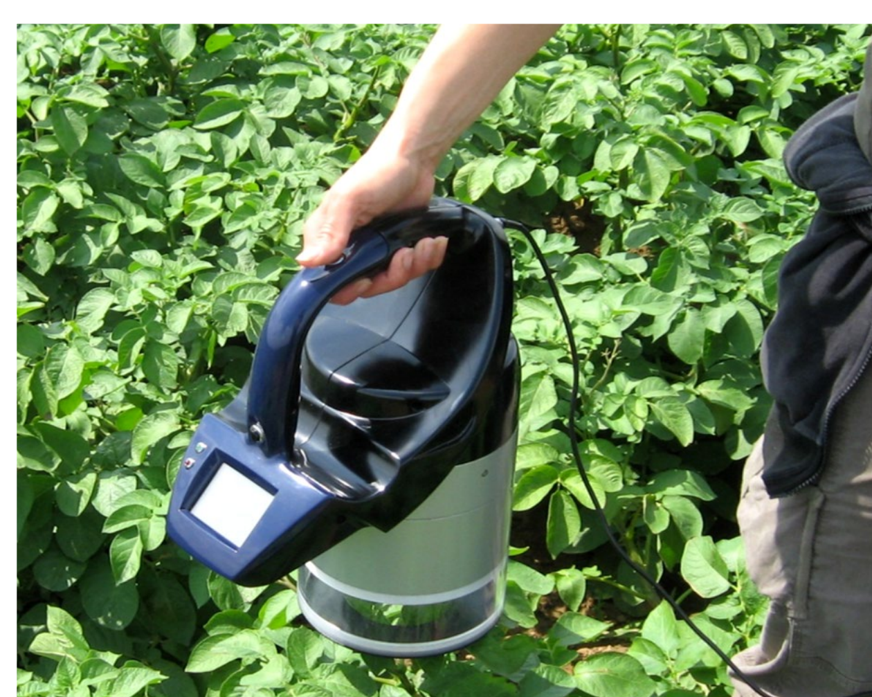
Multiplex (Force-A, Paris, France) Chlorophylle –Flavonoïdes Fluorescence chlorophyllienne - transmittance
