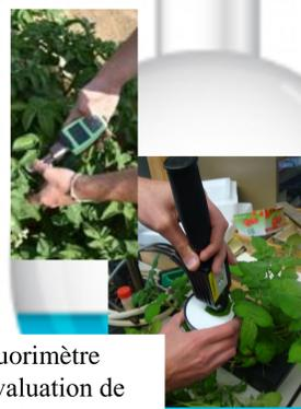
Spectromètre et fluorimètre portables pour l'évaluation de stress sur plantules de pommes de terre cultivées en phytotron
