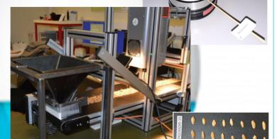
Évaluation de stress sur épis collectés et contaminants/impuretés sur récolte de grains par spectrométrie portable et imagerie hyperspectrale
