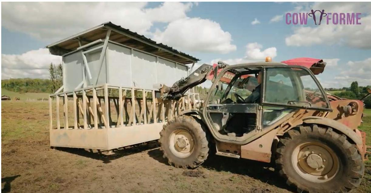
*L'éleveur wallon Patrick a conçu et fabriqué plusieurs outils qui rendent son travail plus sûr et moins exigeant physiquement. Par exemple, ce râtelier à fourrages transportable. Le toit s'ouvre pour lui permettre de charger facilement une grosse botte de paille. Cela lui permet de nourrir environ 34 vaches à la fois.*
