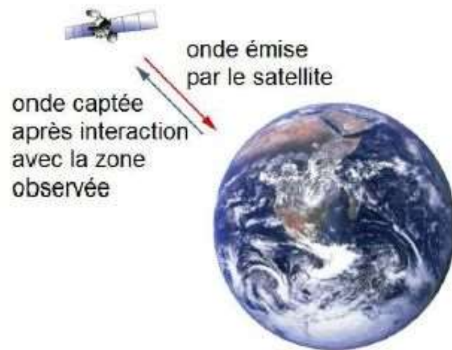
Principe de la télédétection active
