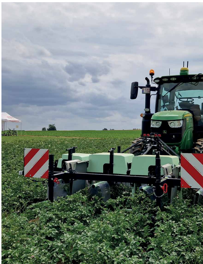
L'« attrape doryphores », développé par FieldWorkers (Pays-Bas) et testé dans le cadre de la visite des essais Patat'Up du 04/07/23.
