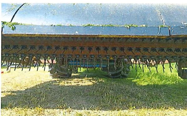
Exemple de prototype avec rotor à dent
