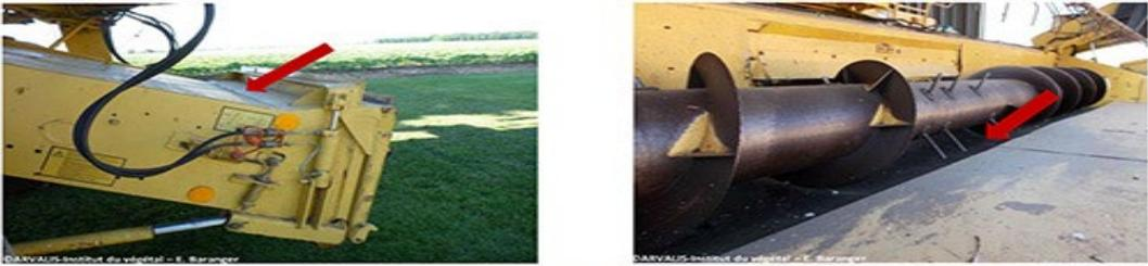
**2** Ouvrir et vider le bac à pierre sous le convoyeur.
