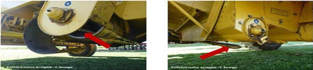
**5** Nettoyer l'intérieur de la trémie si besoin (formation d'amas dans les angles) et ouvrir la trappe de vidange si présente.
