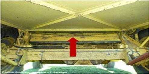
**3** Si la machine est équipée de grilles réglables : les ouvrir à fond. En cas de grilles à trous les sortir pour nettoyage.
