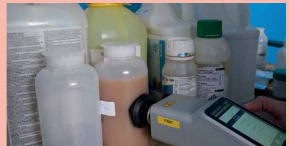
Mesure d'une formulation de pesticide par appareil Raman portable
