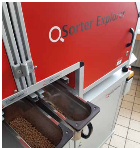
Tri optique grain à grain de pois avec le QSorter Explorer (QualySense, CH)
