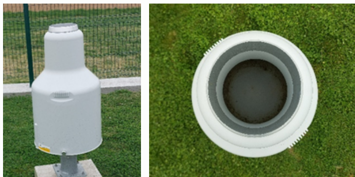
Figure 5 : Pluviomètre à pesée en vue de face (gauche) et en vue de haut (droite) (CRA-W, 2025).
