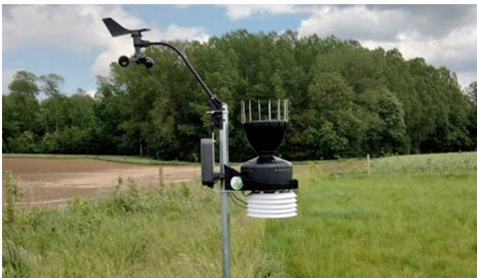
Figure 13 : Station météo connectée sur une parcelle à Meux (CRA-W, 2025).
