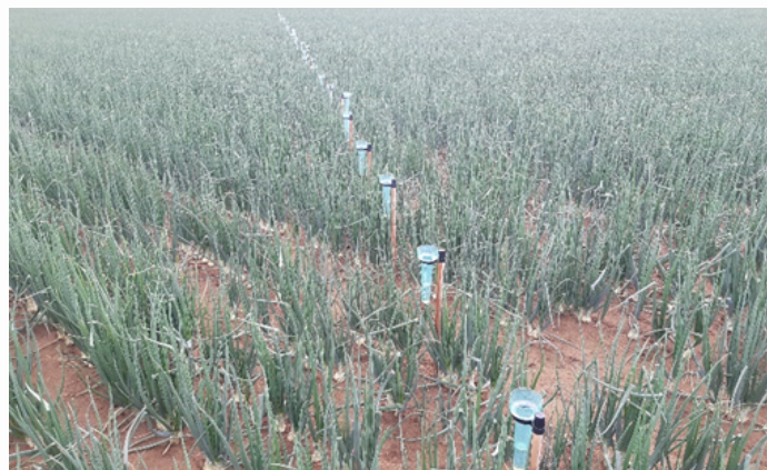
Figure 9 : Disposition des pluviomètres avec un écartement d'un mètre pour quantifier la variabilité de l'irrigation en culture d'oignons (CRA-W, 2023).
