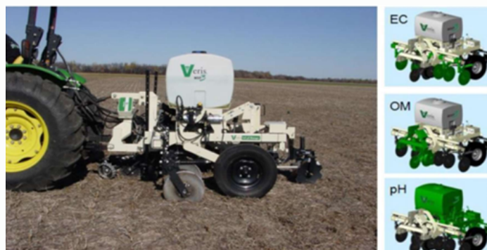
Figure 1 : Photo du Véris MSP3 et schémas de chacun des 3 capteurs le composant (Vantage Agrometius, 2025).
