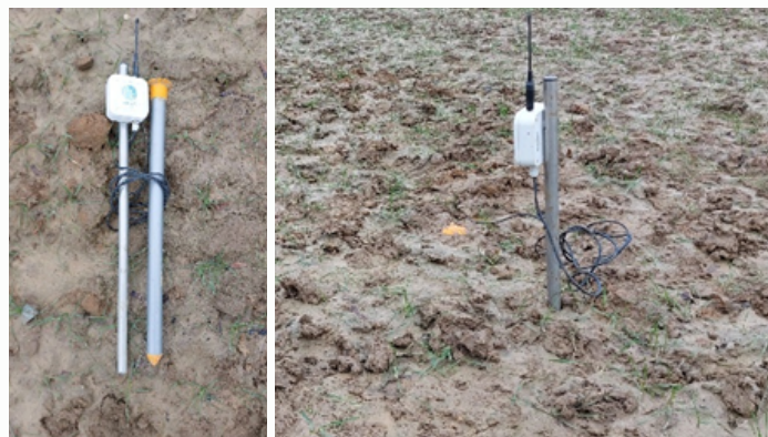
Figure 6 : Photos d'une sonde capacitive avant et après installation (CRA-W, 2025).
