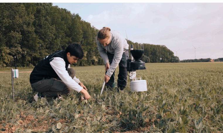
Figure 7 : Suivi de l'humidité du sol par une sonde capacitive Sentek pour une culture de pomme de terre en 2024 sur l'ensemble du profil racinaire (Sentek).
