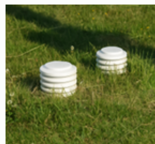
Figure 9 : Abris anti-radiatifs et leur sonde de température au niveau du couvert herbacé (CRA-W, 2020).
