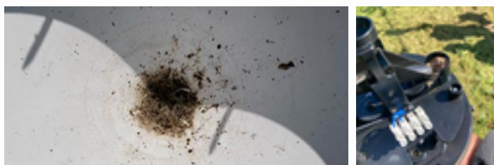
Figure 16 : Entonnoir et système intérieur d'un pluviomètre à auget bouché.
