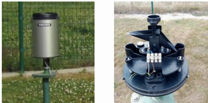
Figure 4 : Vue extérieure et intérieure d'un pluviomètre à auget basculant (CRA-W, 2025).
