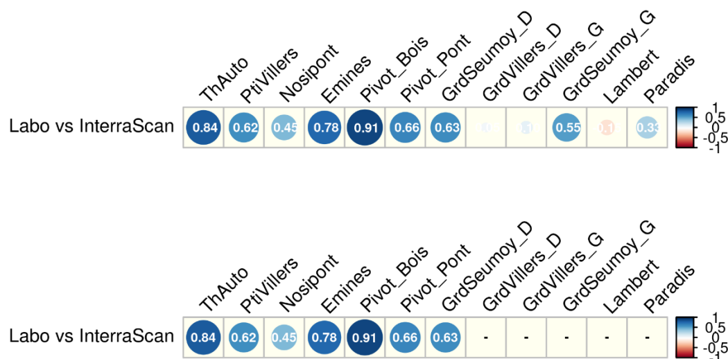
Figure 23. Matrices de corrélation entre les mesures de taux d'argile réalisées par le laboratoire BW et les mesures issues des solutions TerraScan à l'échelle des parcelles. Les parcelles sont classées selon leur degré d'hétérogénéité en taux d'argile, estimé à partir des résultats du laboratoire BW : les plus hétérogènes figurent à gauche de la matrice, les moins hétérogènes à droite. La matrice supérieure présente l'ensemble des résultats par parcelle. Dans la matrice inférieure, les parcelles sans variation significative (cv < erreur de mesure) ont été masquées.
