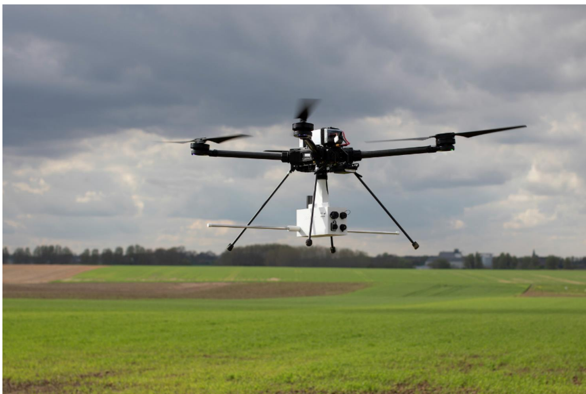
Figure 1. Système radar gprSense® monté sur drone pour la cartographie de l'humidité de la zone racinaire dans le cadre du projet DuraTechFarm. Le radar, opérant dans la gamme 110–120 MHz, est intégré sous un drone Tundra (Hexadrone) et permet des acquisitions automatisées sans contact avec le sol ni perturbation des cultures. Photographie : Sébastien Lambot.
