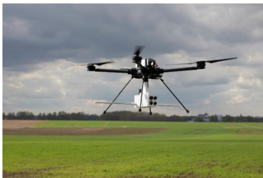
Figure 5. Système radar gprSense® monté sur drone pour la cartographie de l'humidité de la zone racinaire dans le cadre du projet DuraTechFarm.
