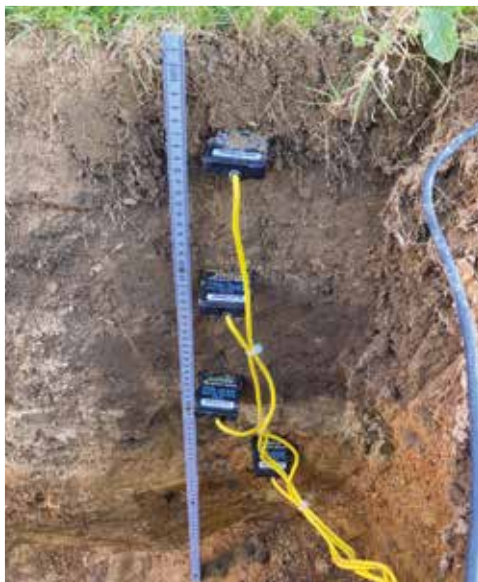
< Sondes d'humidité insérées dans le sol depuis la fosse pédologique.
